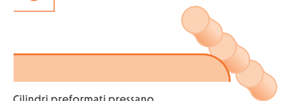
Cilindri preformati pressano il laminato sul profilo del pannello
